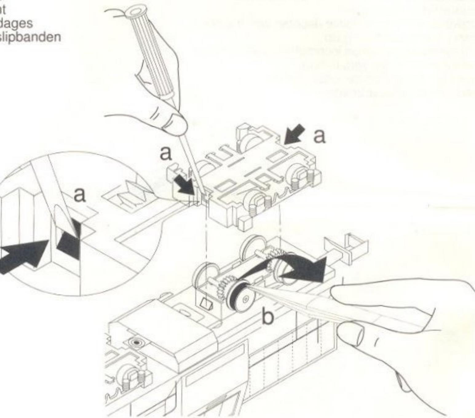
Bei den Arbeiten an dieser hochwertigen Lok kann die feine Mechanik und die elektrische Kontaktierung beschädigt werden. Diese Arbeiten sollten verständlicherweise nur von geschulten Service-Fachleuten ausgeführt werden.
