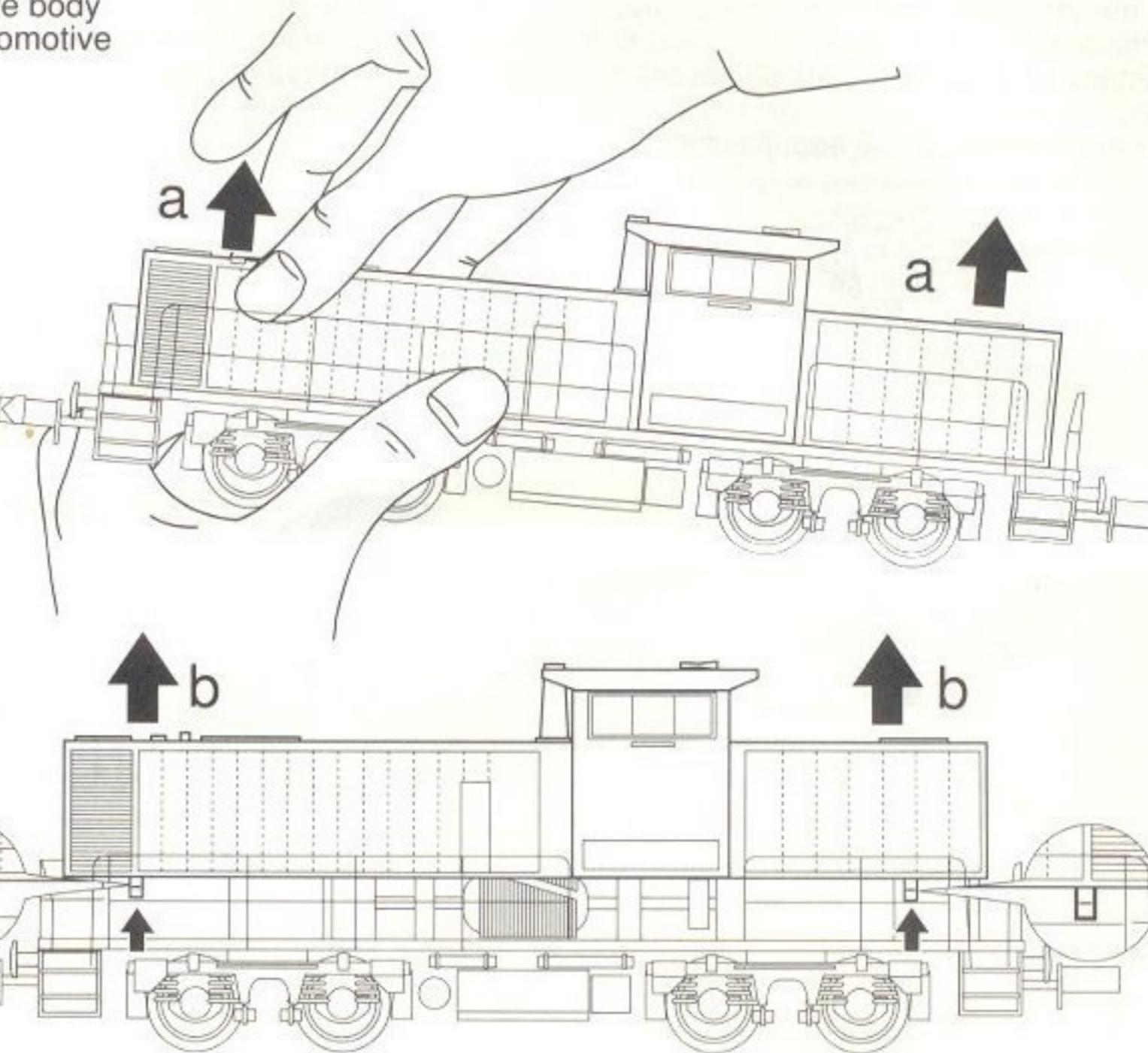
Einbau des Lok-Decoders mit der schwarzen
